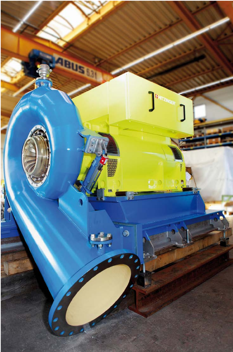
Abb. 6: Wasserwerk Sösetal der Harzwasserwerke: Francis-Turbinen-Generatoreinheit, Leistung 153 kW, mit Schwungmasse für Inselbetrieb
