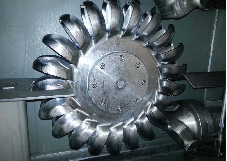
Abb. 2: Laufwerk der Pelton-Turbine Obermaubach
